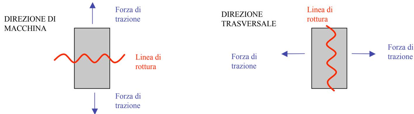
**CARICO di ROTTURA**, il limite di resistenza alla trazione.
